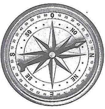
La Terre est comme une grande boussole avec un pôle Nord et un pôle Sud. Comme l'aiguille rouge de la boussole est aimantée, elle se place dans le même sens que le champ magnétique de la Terre. Ainsi elle prend la direction du pôle Nord.
